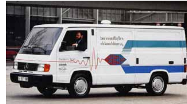
1993 führte Mercedes-Benz den MB 100 Transporter ein, der seinen Strom aus einem 800 kg schweren Brennstoffzellen-Stack bezog.
