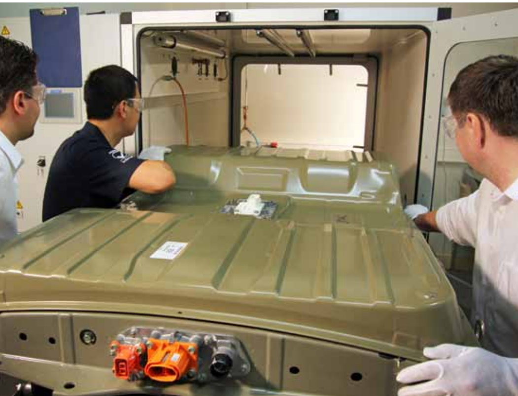
Vorbereitung einer Elektrofahrzeug-Traktionsbatterie auf eine Staubeintrittsprüfung in einer Spezialkammer. Hierbei kommt Arizona-Staub mit einer Korngröße 7,5 µm zum Einsatz.
