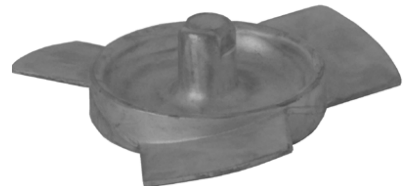
Bild: Das endkonturnahe Schmieden von Magnesium-Knetlegierungen ermöglicht die Herstellung deutlich gewichtsreduzierter Bauteile. Dieser Rotor mit 85 mm Durchmesser und 20 mm Zapfenhöhe wiegt lediglich 21 g.
