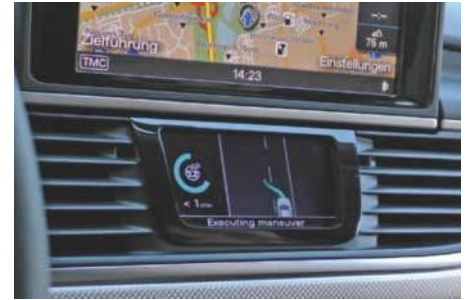
Op een extra centraal display wordt statusinformatie getoond die alleen voor de file-piloot bedoeld is.
