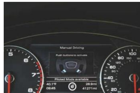
Op het informatiedisplay word je gevraagd de besturing over te geven door de twee knoppen op het stuur in te drukken.
