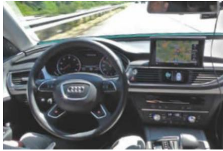
Het stuur schuift terug, de ledstrip brandt nu over de hele breedte van de voorruit. De auto rijdt autonoom.
